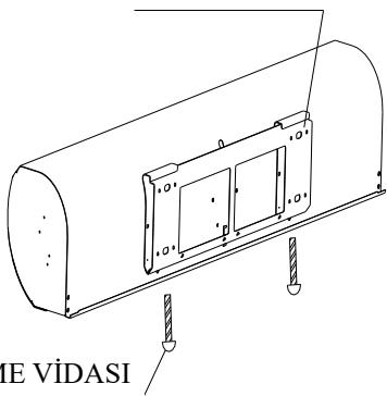
5.3.3 Montaj plakasını tavana montaj ayaklarının üzerinde ayarlayın ve vidaları kullanarak emniyetli bir şekilde sabitleyin. Tavana asmak için tavana montaj ayaklarını kullanın, montaj plakasının pozisyonu 100mm sınırlar içinde ayarlanabilir.
