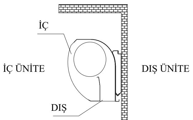
4.3 Ünitenin montajını çok alçak bir seviyeye yapmayın, zeminden en az 2,3 metre yükseklikte olması gereklidir.
